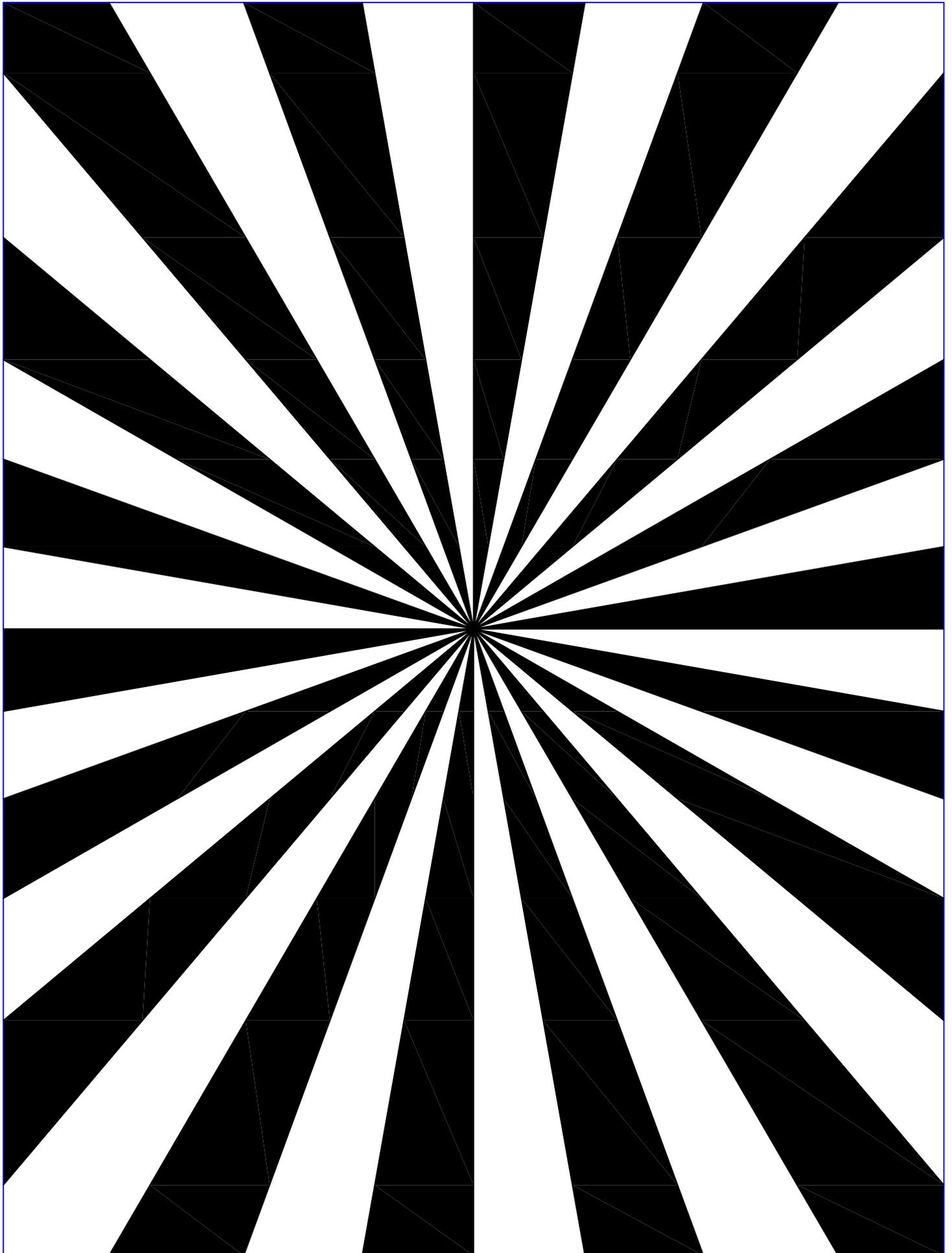
Mire de réglage de mise au point pour les lentilles de remplacement pour caméra GoPro
